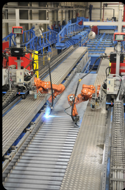
Fot. 3. Automatyczna linia do produkcji profili SIN
